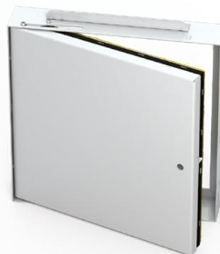
Súčasťou dvierok sú 4 ks oceľových L profilov, ktoré sa priskrutkujú na vonkajší rám a umožňujú tak montáž do sadrokartónovej steny s hrúbkou 12,5 až 36 mm. Na inštaláciu do murovanej šachty nie sú profily potrebné.
