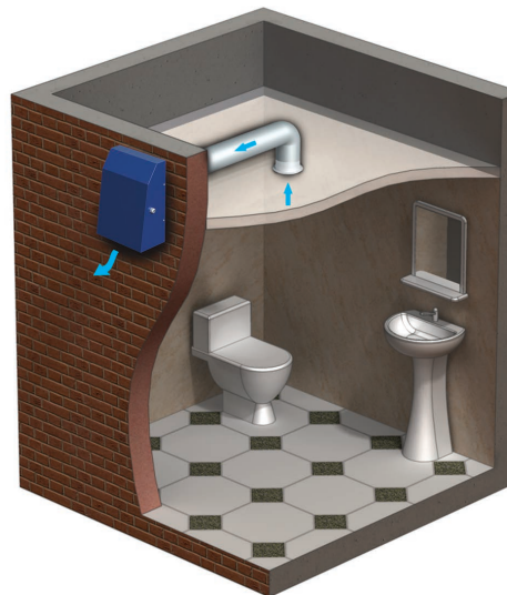
Príklad vetrania WC ventilátora VCN
